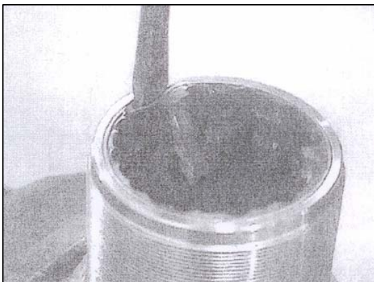
Continuer à marteler pour décoller le manchon
